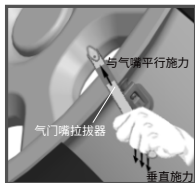
3. 使用气门嘴拉拔器 安装传感器总成
